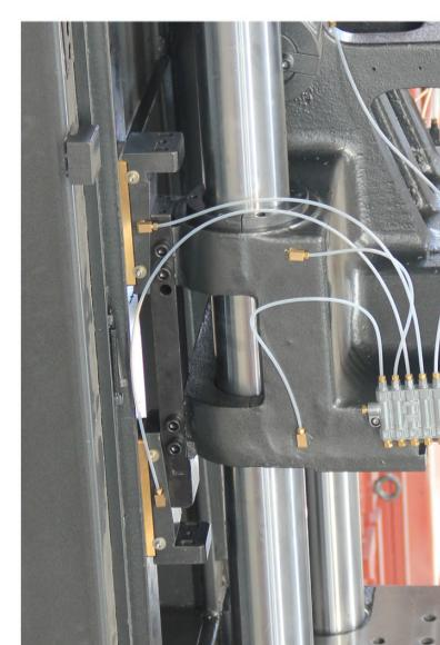
④ 整体拆装顶出油缸部件结构；
